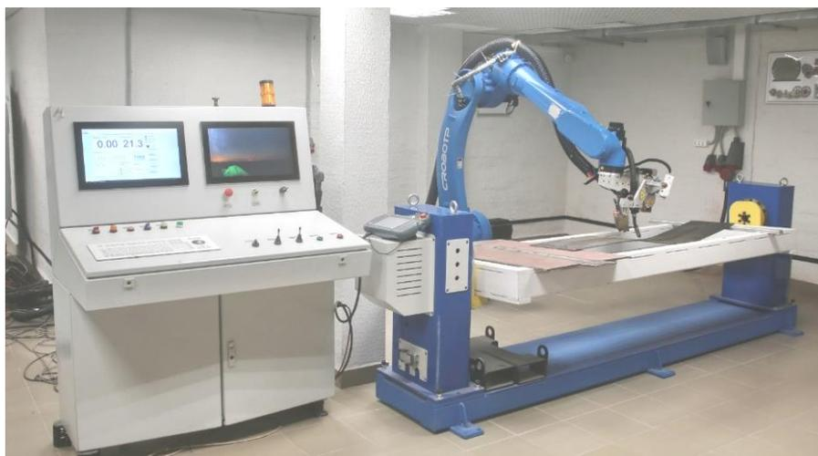
Рисунок 4.16.1. Фотоматериалы СОП «ИКОП «Лабораторный комплекс (линия) лазерной и гибридной лазерно-дуговой сварки судовых металлоконструкций»
