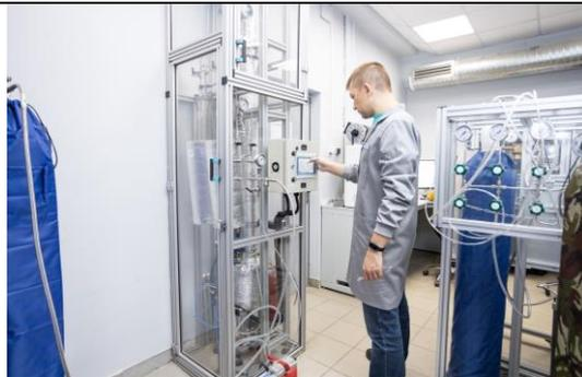
Рисунок 3.1.4. Фотоматериалы СОП «Опытное производство высокочистых материалов для микроэлектроники». Работа ректификационной установки очистки гексафторида вольфрама
