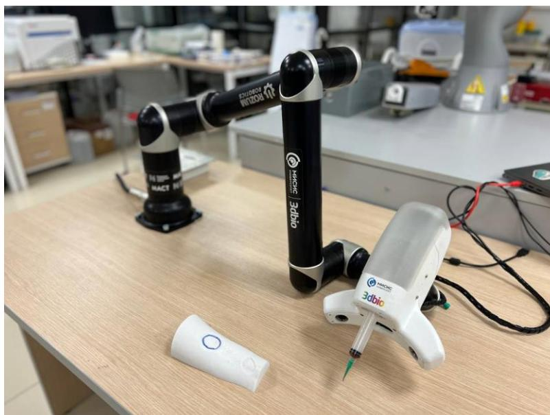
Рисунок 2.50.2. Фотоматериалы СОП «Лаборатория «Биофабрикация». Разработанный макетный образец in situ биопринтера
