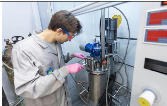
Рисунок 3.1.1. Фотоматериалы СОП «Опытное производство высокочистых материалов для микроэлектроники». Монтаж пилотного реактора для производства металлоорганических соединений
